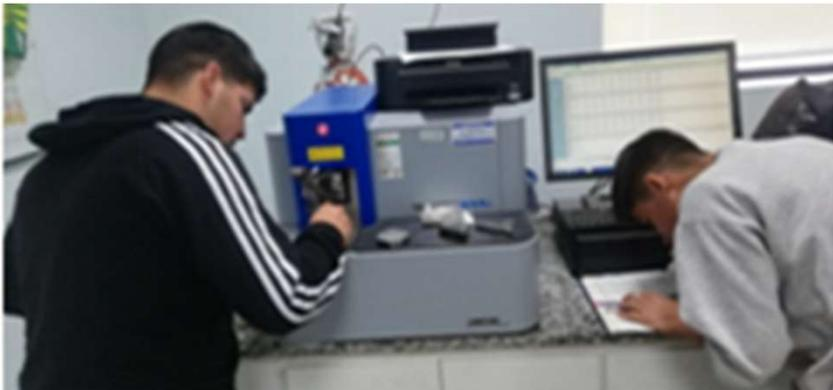
**ENSAYO DE DUREZA**
